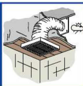
Montáž do stropu
